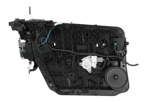
Gegenüber klassischen Kunststofftürsystemen spart die Trägerplatte mit glasgewebeverstärktem Polypropylen rund 350 Gramm Gewicht ein, im Vergleich zu konventionellen Stahltüren sogar knapp 1,2 Kilogramm - bei gleicher Crashsicherheit und hoher Funktionsintegration.
